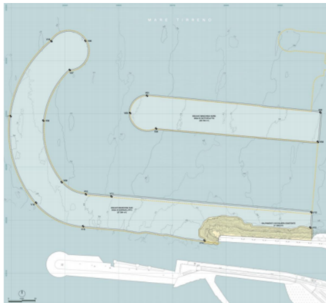
Fig. 65 Il poligono più grande in trasparenza rappresenta Diga di Sopraflutto e la Banchina Sud mentre quello più piccolo in alto indica la Diga di Sottoflutto e la Banchina Nord. Tra le due banchine sarà realizzato l'approfondimento del fondale del bacino portuale alla quota di progetto – 6.00 m s.l.m.m
